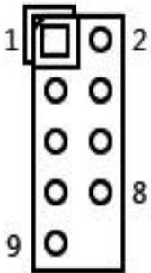
(1) 硬盘指示灯 (第1、3针HDDLED, 第1针为LED的正极) 硬盘在进行读写操作时, 指示灯便会闪烁, 表示硬盘正在运行中;
